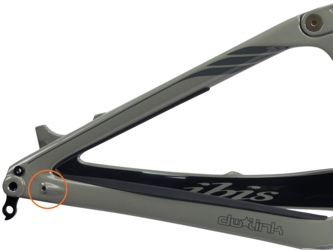
V2 Derailleur Cable Routing
